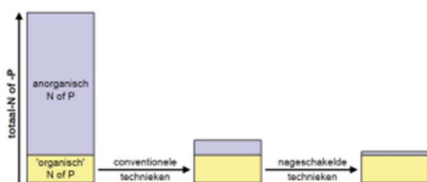
Figuur 1: Schematische voorstelling van het effect van conventionele en nageschakelde zuiveringstechnieken op N- en P-fracties in het effluent (Stowa, 2009-03).
